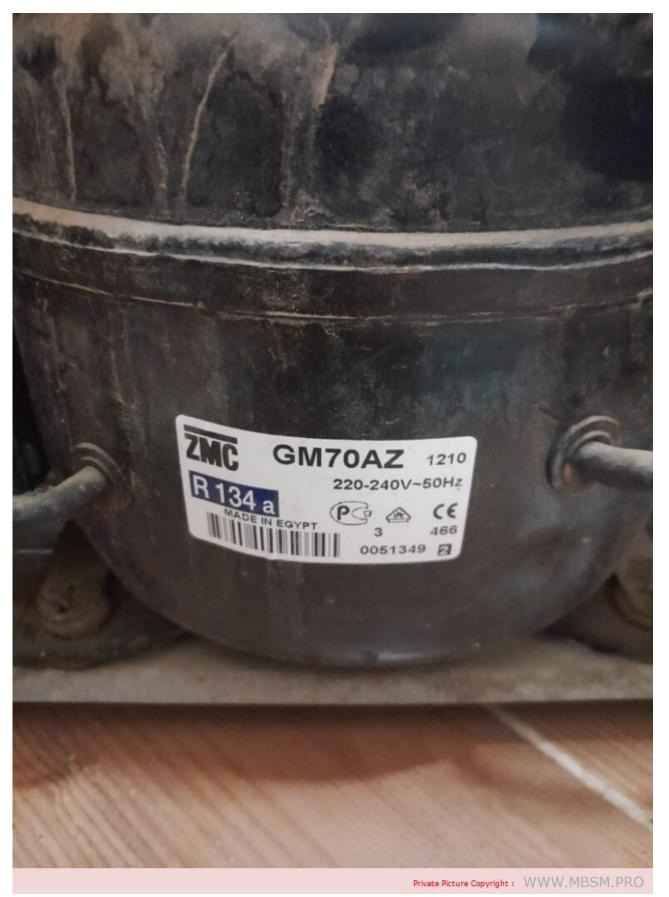
Le ZMC GM70AZ est un compresseur hermétique à piston fonctionnant au R134a, destiné aux applications à basse pression d'aspiration dans les réfrigérateurs et congélateurs ménagers alimentés en 220–240 V, 50 Hz. Fabriqué par Misr Compressor Manufacturing Co. en Égypte, il fournit une puissance d'environ 1/5 HP et une plage d'évaporation de -30 °C à -10 °C, ce qui en fait une solution courante et fiable pour le froid domestique dans la région MENA
