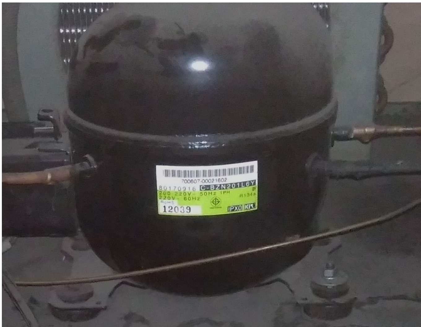
Compresseur Sanyo C-BZN201L6Y, 1 / 4cv
