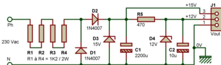
Contrairement à ce qu'on pourrait peut-être penser, ce schéma n'est pas capable de fournir un courant beaucoup plus important que son homologue à condensateur. On est en effet assez vite limité par la dissipation de puissance des résistances R1 à R4, qui au final, et pour une consommation similaire, prennent
