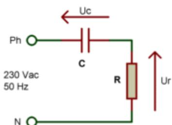
Mais la formule  $R = U / I$  que l'on utilise pour calculer la valeur d'une résistance en fonction de la chute de tension qu'elle doit provoquer sous un courant donné, ne convient pas (voir page Abaissement tension). Au lieu de celà, nous devons utiliser une formule où apparaît un terme lié à la fréquence de la tension alternative à abaisser (50 Hz du secteur 230 V, en ce qui nous concerne).
