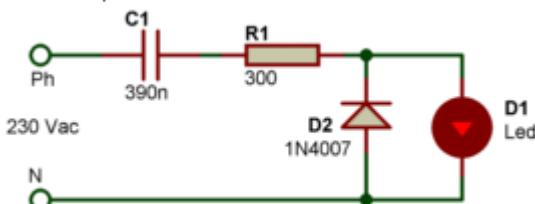
La résistance R1 limite l'appel de courant quand le condensateur est déchargé. Sa valeur doit être déterminée en fonction de la capacité du condensateur et de la pointe de courant que l'on accorde, mais de manière générale, on estime que sa valeur doit être de l'ordre de
