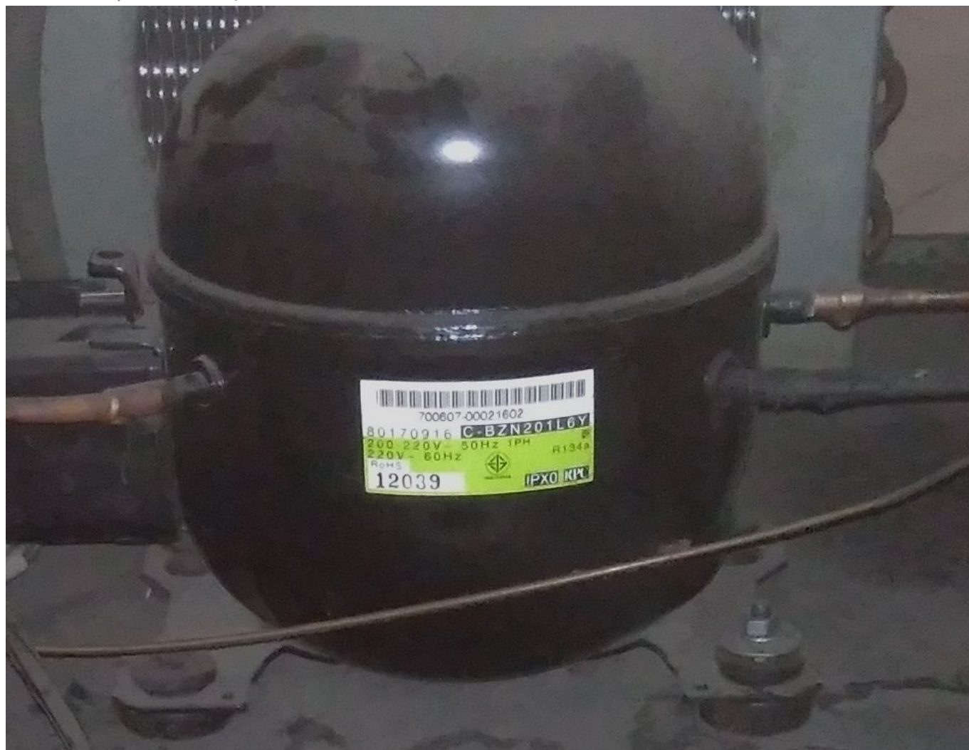
Compresseur Sanyo C-BZN201L6Y, 1 / 4cv
