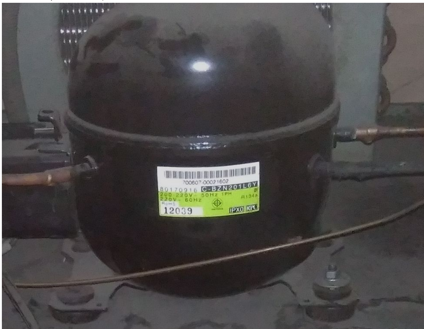
Compresseur Sanyo C-BZN201L6Y, 1 / 4cv
