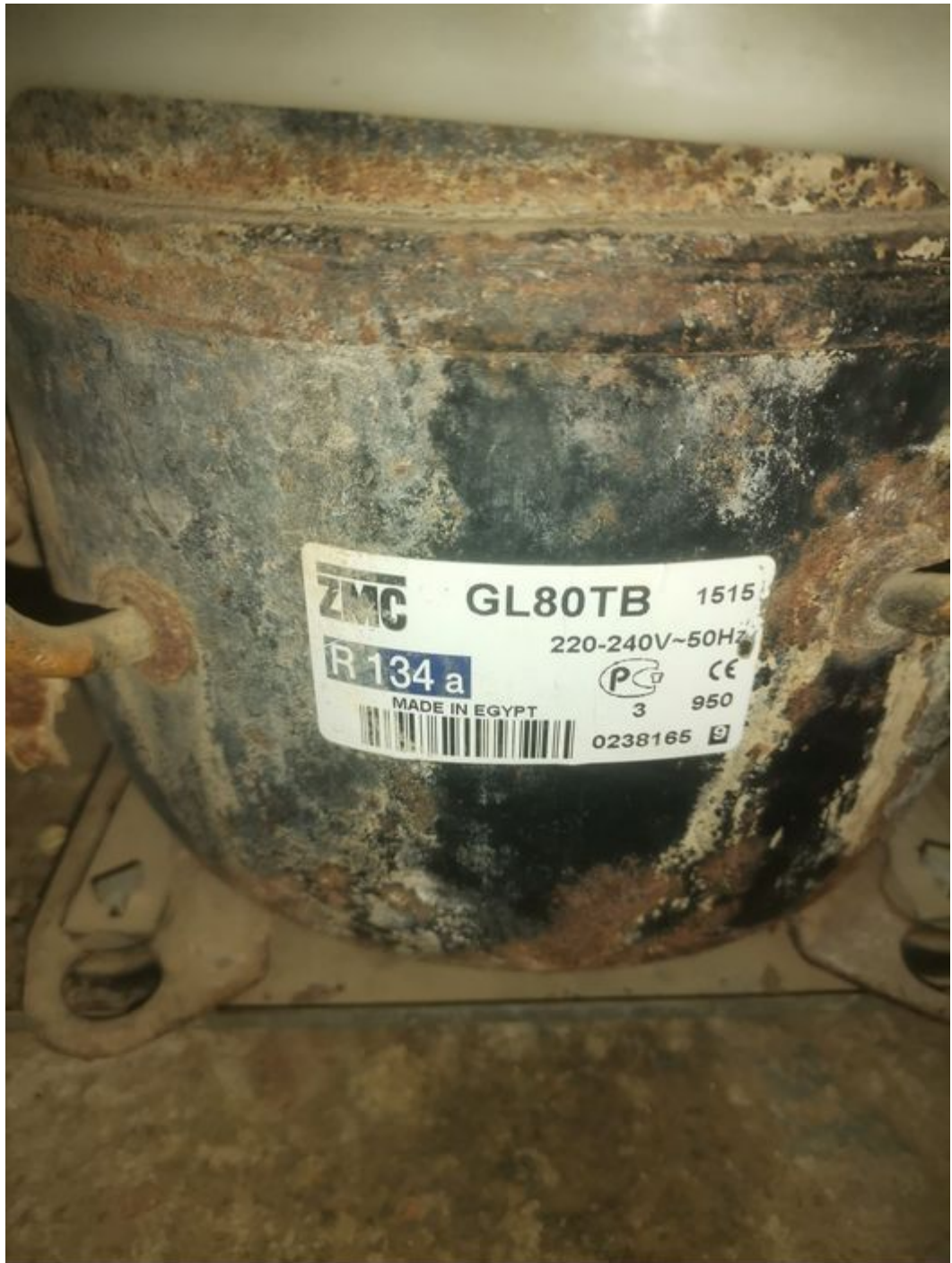
Compressor ,Moteur HP ,CSIR ,Avec Condensateur ,CUBIGEL ,GL80TB ,R-134a 1/5HP ,230V ,HMBP ,High-Medium Back Pressure
