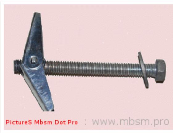
Le segment à ancrage est simplement une vis avec des ailes en métal qui vont se replier contre le dos du mur quand vous le vissez en place. Il faut s'en procurer pour l'épaisseur du matériel du panneau, car les plis dans les ailes sont faits pour s'y ajuster.
